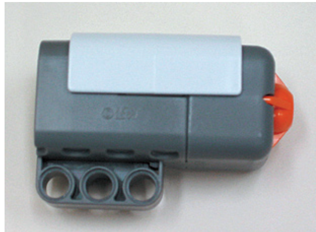
図10 MINDSTORMS NXTタッチセンサー
